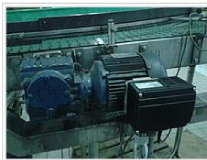
Рисунок 1.6 - Привод с частотным регулированием для конвейерной установки
